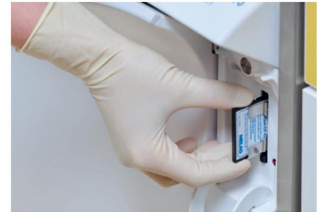
Für höchste Sicherheit überwachen die MELAG Thermodesinfektoren alle relevanten Prozessparameter. Die erstellten **Protokolle sind rechtssicher und können per CF-Card oder den beiden Netzwerkschnittstellen ausgelesen werden.**
